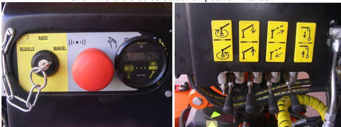
Soit en utilisant la radiocommande. Pour passer en mode radiocommande, tourner la clé du sélecteur ( position radio ) situé sur la colonne de la grue.
