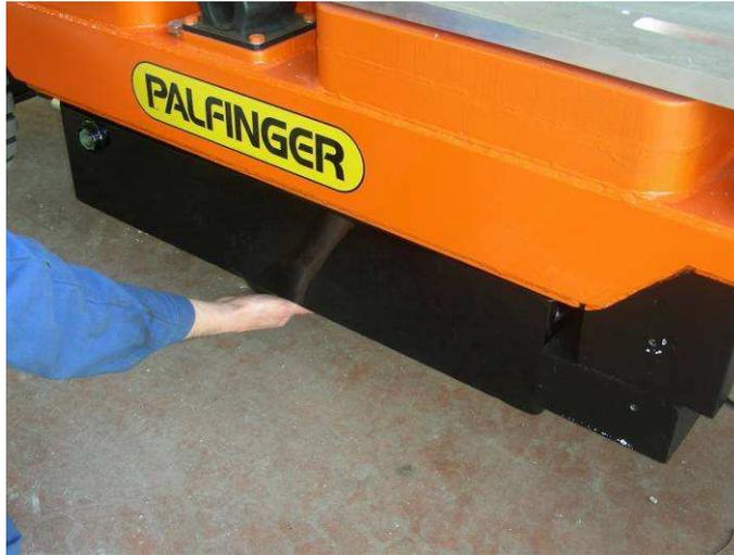
Dévisser le bouchon situé sur le dessus du réservoir afin de faire le remplissage d'huile Cf. Page 6.1-6 huile hydraulique du manuel d'entretien de la grue PALFINGER PC2300
