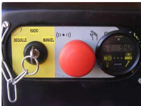
Allumer la radio en appuyant sur le bouton en bas à droite ( vérifier que le bouton d'arrêt d'urgence n'est pas enclenché)
