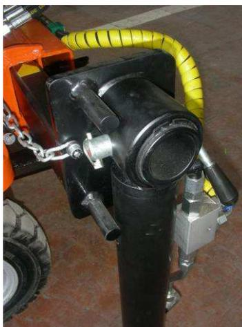
Actionner le distributeur pour descendre les stabilisateurs – les stabilisateurs doivent être mis en place ( et relevés ) à une extrémité et ensuite à l'autre de la remorque.
