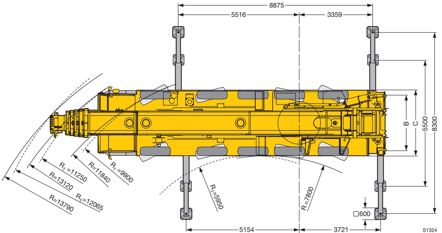
R<sub>1</sub> = mit unabhängiger Hinterachslenkung / with independent rear-axle steering / à direction essieu arrière indépendante
