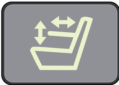
Cette image est affichée lorsque l'interrupteur de rotation du poste de conduite est actionné et lorsque l'accoudoir droit n'est pas dans la zone autorisée.
