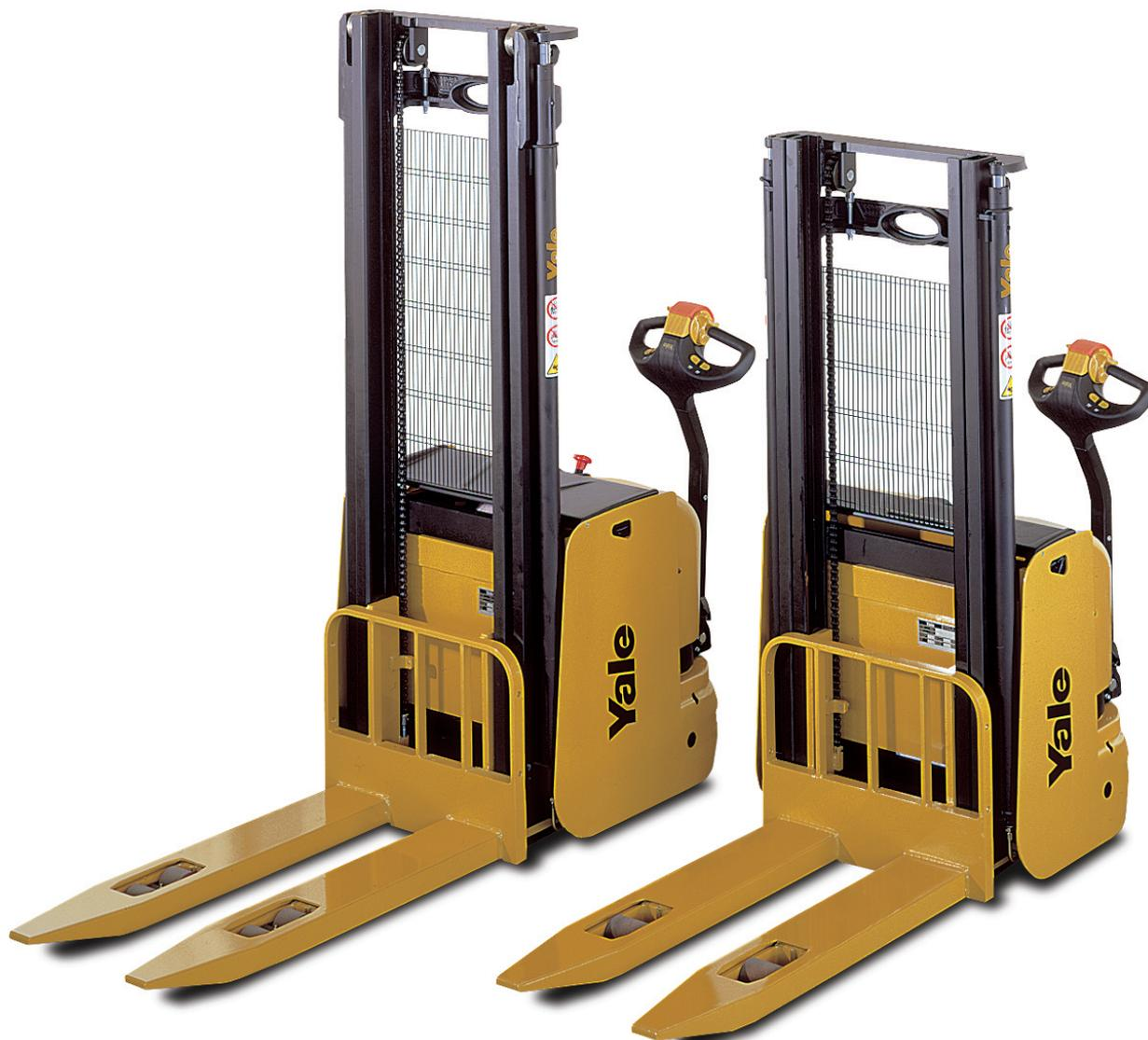
commande progressive, en douceur, est disponible à tout moment. Le variateur est doté du freinage automatique (freinage à contre-courant) et du freinage par régénération. Le relâchement des boutons papillons induit ces deux freinages. Le variateur est également doté d'un système anti-recul et anti-démarrage en pente.
